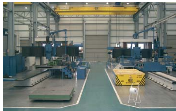
< Montering av bearbetningscentrum för Arbormning och fräsning.
