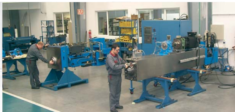
^ Del av montageprocessen för spindeldockor och RAM Funktionsprovning.
