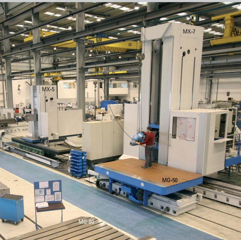
^ Del av montageprocessen för spindeldockor och RAM Funktionsprovning.
