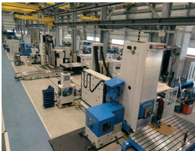
< Montering av bearbetningscentrum för Arbormning och fräsning.
